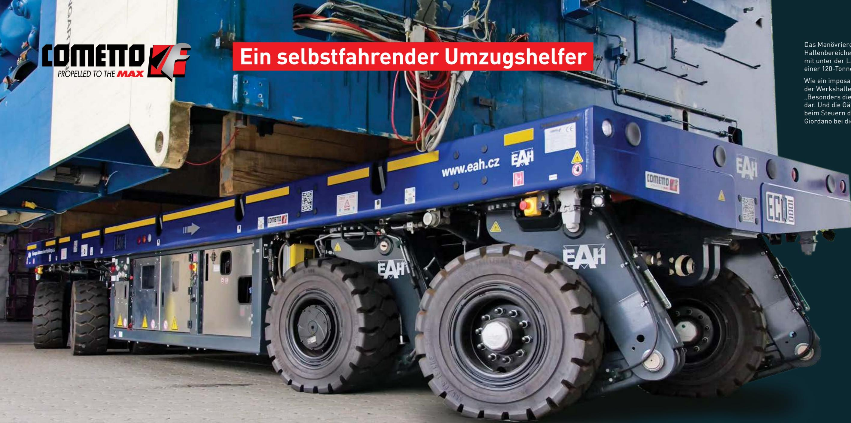
Das Manövrieren von schweren und kompakten Ladungen durch enge Hallenbereiche gehört zu den Stärken von Selbstfahrern. Ein 4-Achs Eco1000 mit unter der Ladefläche integriertem Power-Pack erledigt den Transport einer 120-Tonnen-Presse mit Bravour.
