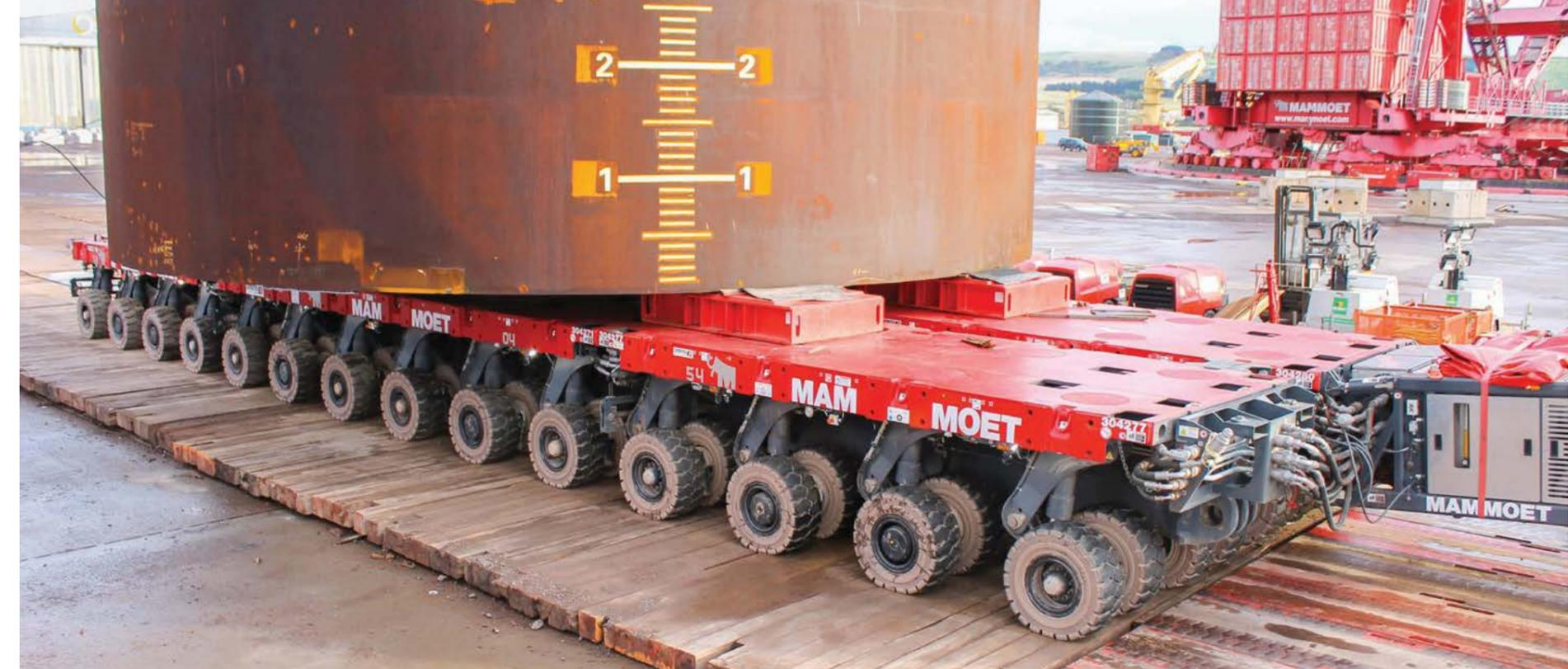
Der Weltmarktführer Mammoet setzt nun auch Cometto SPMT als neuen Typ und Marke in seiner selbstangetriebenen Modulfahrzeugflotte ein. Ein erster Einsatz erfolgt im Vereinigten Königreich mit 84 Achslinien zum Transport von Plattformen mit einem Gewicht zwischen 1.850 und 2.300 Tonnen. Die neue Zusammenarbeit zwischen Cometto und Mammoet führt zu einer fruchtbaren Kombination von zwei Partnern, die führende Kompetenz im Spezial- und Schwertransportgeschäft vereinen.
